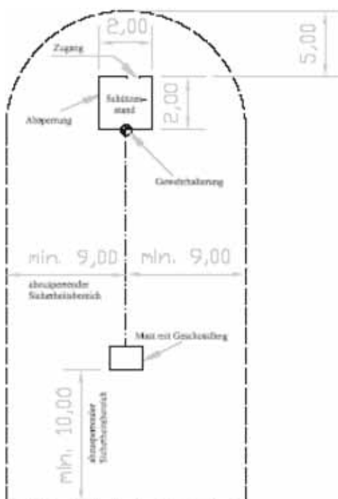
Abbildung 7.9.1 Sicherheitsbereich für Vogelschießstände
